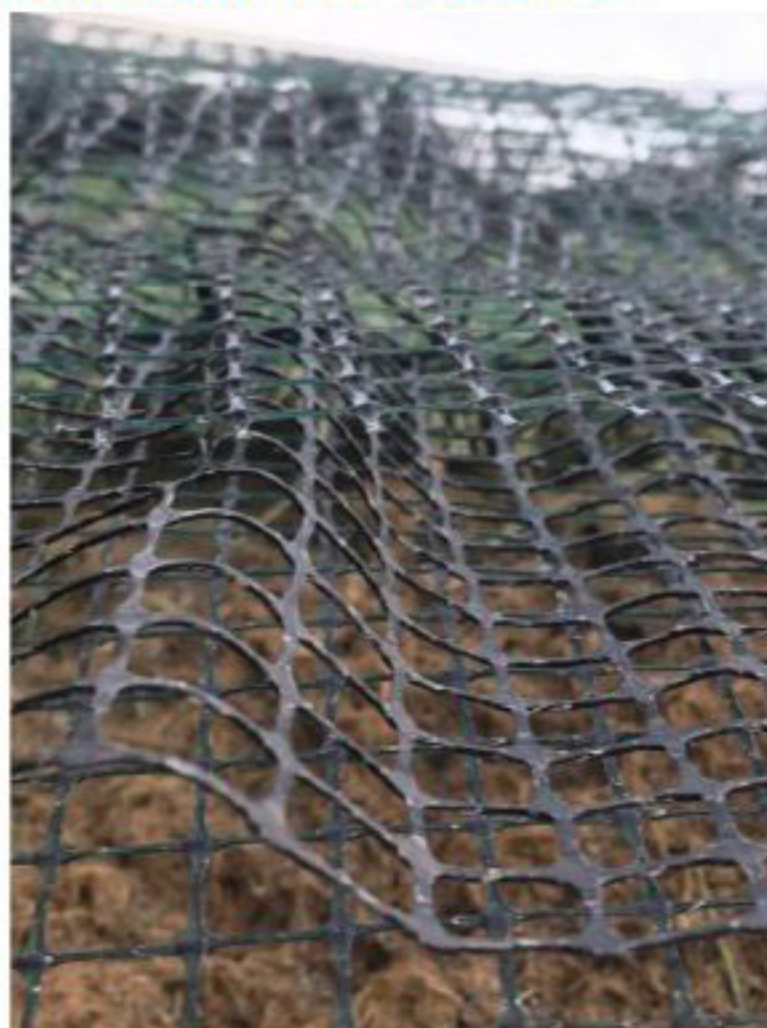
Configuración de la manta anti erosión TRM Multiestrats®
